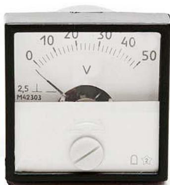
Вольтметр М42303 предназначен для измерений напряжения в электрических цепях постоянного тока.
