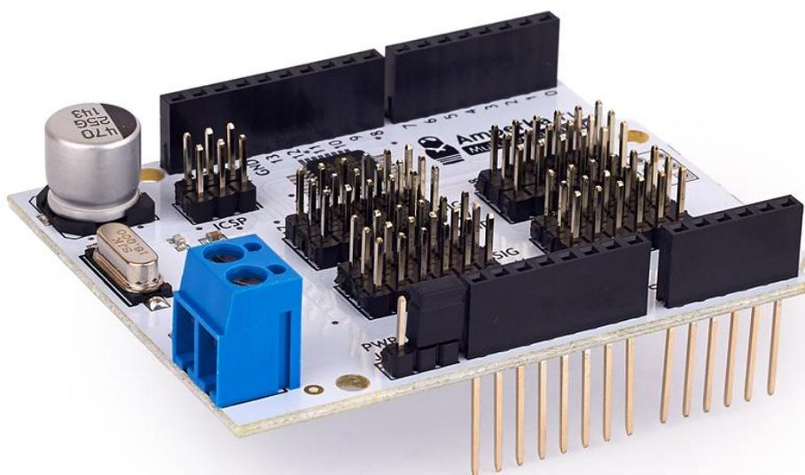
*Multiservo Shield* — это плата расширения для Arduino Uno, позволяющая управлять 18-ю
