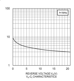
CAPACITANCE BETWEEN TERMINALS:C<sub>t</sub>(pF)
