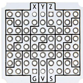
Вашему проекту требуется Тройка-модуль, до которого у нас пока не дошли руки? Создайте его сами. Разместите необходимые компоненты в отверстиях Тройка Protoboard и припаяйте. Добавьте штырьковые соединители в качестве ножек и всё — уникальный модуль готов.
