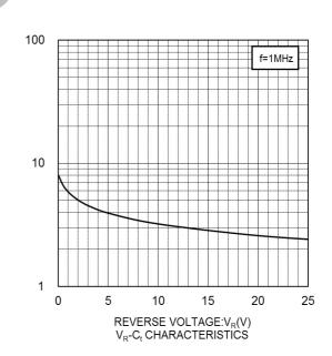
CAPACITANCE BETWEEN TERMINALS:C<sub>t</sub>(pF)
