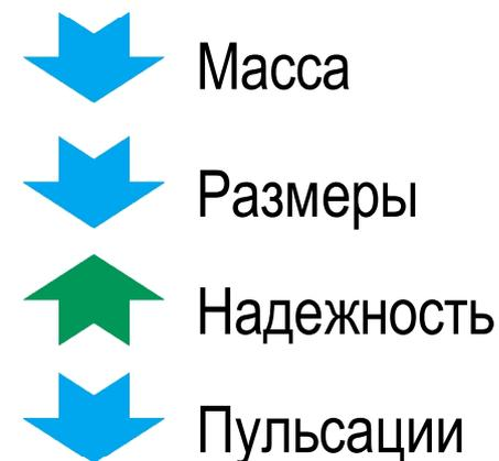
Сочетание первичного трансформатора, вторичного импульсного стабилизатора и дополнительного линейного регулирования уменьшает массу и размеры, оставляя неизменными надежность и малый уровень пульсаций.
