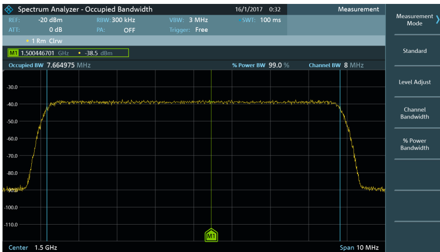
Опция R&S®FPC-K55: занимаемая полоса частот.
