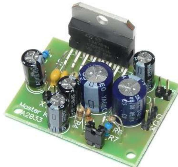
Предлагаемый блок - это надежный мощный усилитель НЧ, обладающий малыми габаритами, минимальным числом внешних пассивных элементов обвязки, широким диапазоном питающих напряжений и сопротивлений нагрузки. Усилитель можно использовать как на открытом воздухе, так и в помещении в составе Вашего музыкального аудиокomплекса. Усилитель хорошо зарекомендовал себя как УНЧ для сабвуфера.
