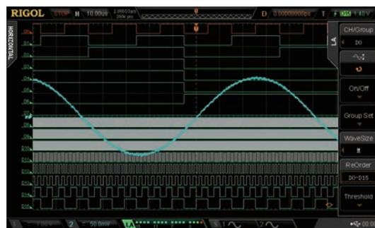
2 встроенных канала и источник тактовой частоты 25 МГц (модели -S)
