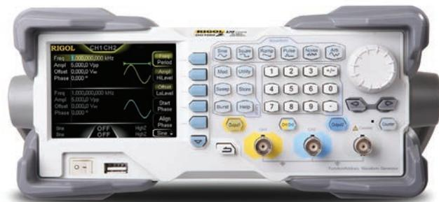
Приборы серии DG1000Z представляют собой многофункциональные генераторы, объединяющие в себе возможности генератора импульсов функциональной формы, генератора импульсов произвольной формы, генератора шумовых сигналов, генератора импульсов генератора гармонических колебаний, аналого-цифрового модулятора и частотомера.
