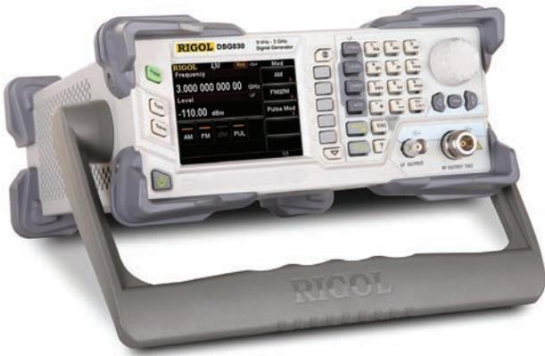
Серия DSG800 формирует новый стандарт экономичных генераторов радиосигналов, отличающихся беспрецедентно низкой стоимостью. В комбинации с экономичным анализатором спектра DSA800 этот продукт становится превосходным решением для проведения радиочастотных испытаний и измерений.
