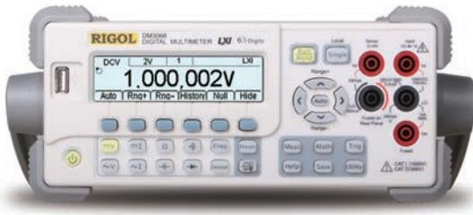
Цифровые мультиметры серии DM3000 (DM3068, DM3058, DM3058E) представляют собой продукты, разработанные для многофункциональных, высокоточных, высокоэффективных и автоматизированных измерений; они характеризуются высокоскоростным сбором данных, высокой точностью, высокой стабильностью, поддержкой датчиков любого типа, широкими возможностями сопряжения.
