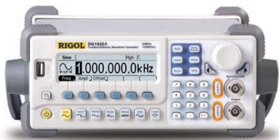
В генераторах импульсов функциональной/ произвольной формы DG1022A используется технология прямого цифрового синтеза. Эти устройства могут формировать точные, стабильные и чистые сигналы с низким уровнем искажения. Они предлагают пользователям два канала с 5 стандартными формами импульсов и возможностью построения 48 сигналов произвольной формы.
