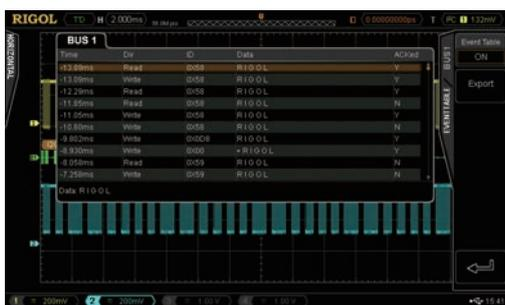
Запуск по сигналам последовательной шины и декодирование при работе с цифровыми каналами
