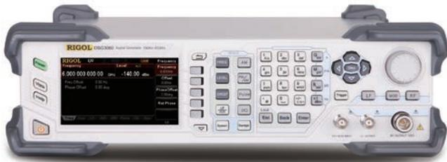
Приборы DSG3000 представляют собой высокоэффективные генераторы радиосигналов, функционирующие в диапазоне от 9 кГц до 3 ГГц / 6 ГГц. Они предназначены для применения в области беспроводной связи, аудио-/ телевидения, образования, бытовой электроники, использования при проведении испытаний ПЛС, применения в качестве прибора общего назначения и
