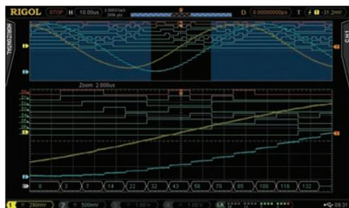
Запуск по сигналам последовательной шины и декодирование (поддержка как аналоговых, так и цифровых каналов)
