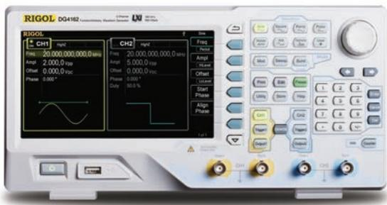
Приборы серии DG4000 представляют собой многофункциональные генераторы, объединяющие в себе возможности генератора импульсов функциональной формы, генератора импульсов произвольной формы, генератора импульсов, генератора гармонических колебаний, аналого-цифрового модулятора и частотомера.
