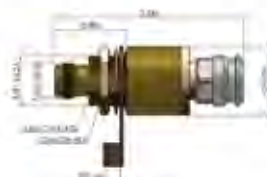
• LP-GTV-RTFM DC Pass RTNC Type F/M
