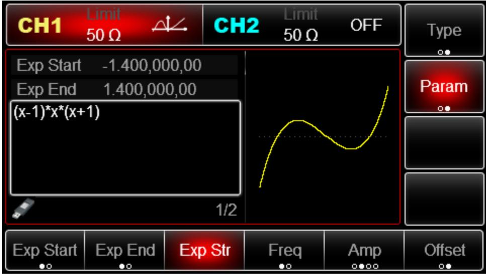
Выходом источника сигнала является дублирующий сигнал в течение ограниченного периода, поэтому необходимо определить диапазон переменной в выражении  $f(x)$ . Диапазон  $x$  определяется начальным значением и конечным значением. Нажмите Начальное значение, чтобы активировать этот параметр. Используйте клавиатуру для ввода 1,4 рад, единицы измерения могут быть ° или рад, интерфейс показан ниже:
