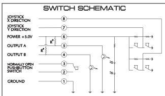
\*EXTERNAL PULL-UP RESISTORS REQUIRED FOR OPERATION (2.2k\(\Omega\)).
