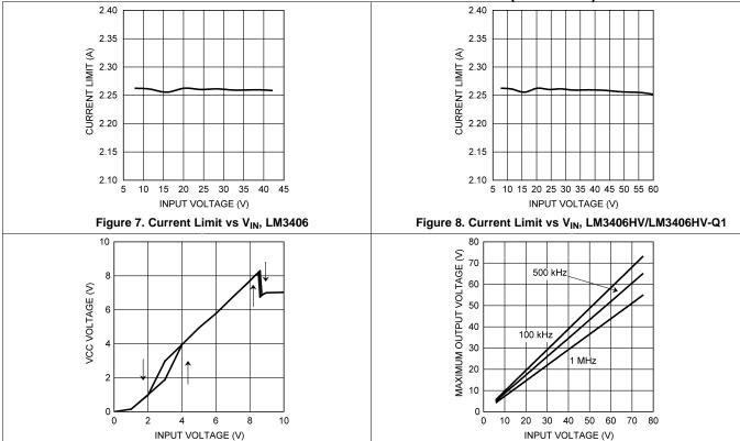
Figure 9.  $V_{\rm CC}$  vs  $V_{\rm IN}$
