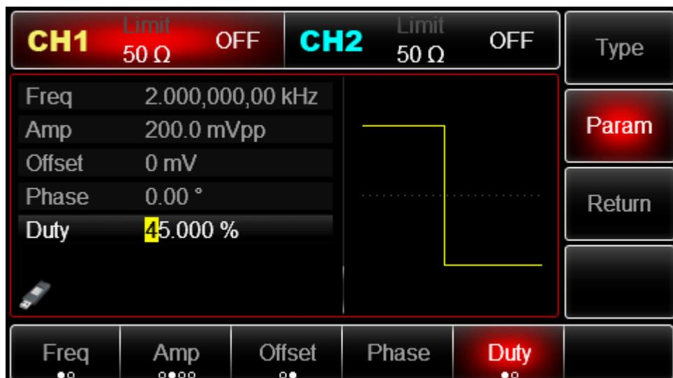
Figure 3 - 8 Set modulation parameter
