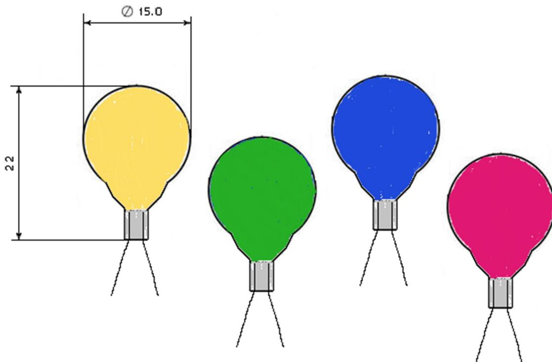
**Лампочки имеют гибкие выводы длиной 6-8 мм. и выпускаются на различные рабочие напряжения.**
