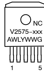
D 2 PAK D2T SUFFIX CASE 936A
