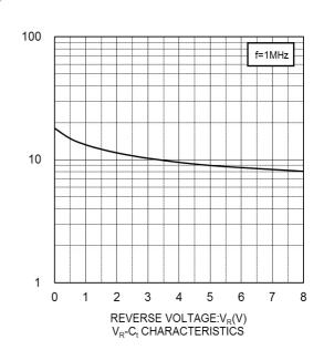
CAPACITANCE BETWEEN TERMINALS:C<sub>t</sub>(pF)
