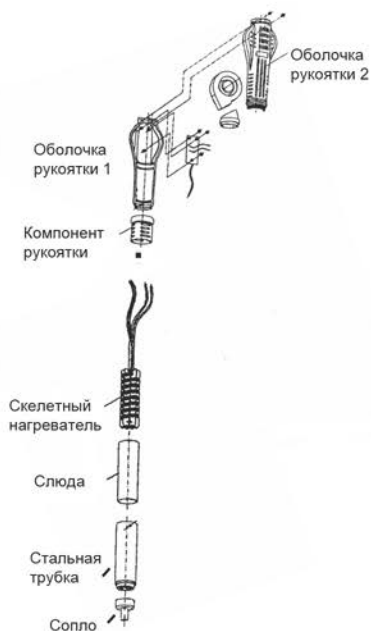
Рисунок 4 Схема сборки термофена
