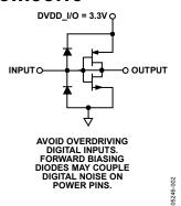
Figure 29. CMOS Digital Inputs
