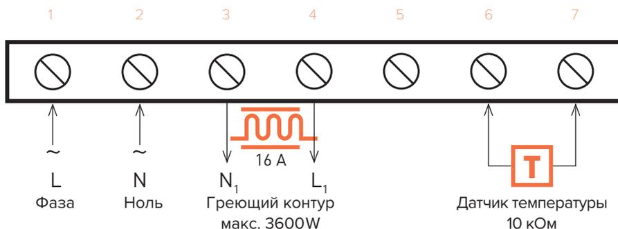
Подключите систему теплого пола к терморегулятору CLIMATIQ BT; PT после полного высыхания плиточного клея в соответствии с рекомендациями производителя. Начертите схематично места установки кабеля, воспользовавшись приложением на стр.13 и зарегистрируйте систему. Процесс регистрации описан в Гарантийном талоне на стр. 14.
