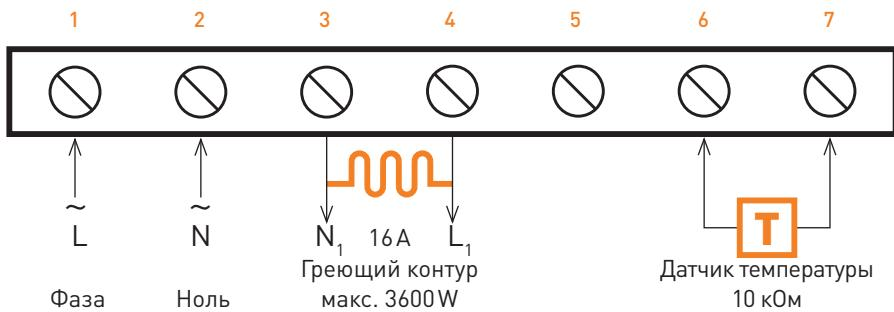
Подключите систему «теплого пола» к терморегулятору IQ THERMOSTAT после полного высыхания стяжки в соответствии с рекомендациями производителя. Начертите схематично места установки кабеля, воспользовавшись приложением на стр. 17 и зарегистрируйте систему. Процесс регистрации описан в Гарантийном талоне на стр. 19.
