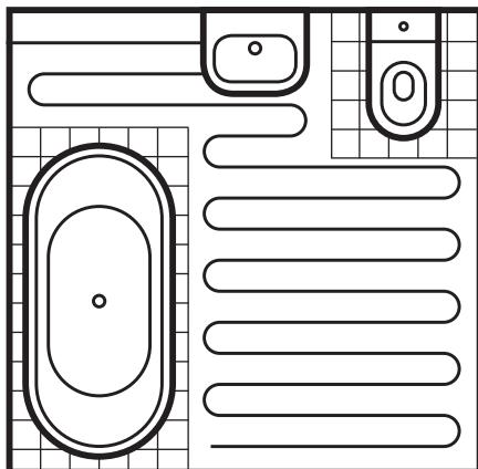
Определите свободную (открытую) площадь под обогрев и подберите греющий кабель IQ FLOOR CABLE. Например: Общая площадь ванной 6.0 м.кв.
