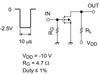
$V_{IN}$ :  $t_r$ ,  $t_f < 5$  ns Common Source
