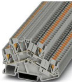
Doppelstockklemme, Anschlussart: Push-in-Anschluss, Querschnitt: 0,14 mm<sup>2</sup> - 4 mm<sup>2</sup>, AWG: 26 - 12, Breite: 5,2 mm, Farbe: grau, Montageart: NS 35/7,5, NS 35/15
