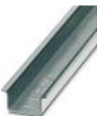
Tragschiene ungelocht, Standardprofil, Breite: 35 mm, Höhe: 15 mm, ähnlich EN 60715, Material: Stahl, verzinkt, weißpassiviert, Länge: 2000 mm, Farbe: silberfarben
