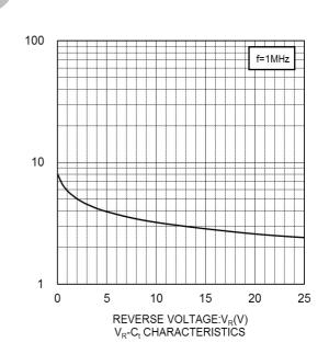
CAPACITANCE BETWEEN TERMINALS:C<sub>t</sub>(pF)
