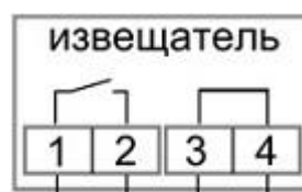
Рисунок 2в. Схема подключения ИО102-51(НР+Пр)
