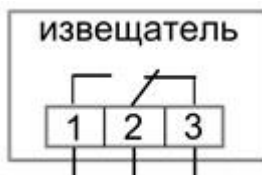
Рисунок 2б. Схема подключения ИО102-51(П)
