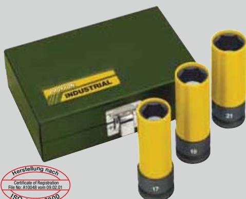
Для использования с пневматическим инструментом на 1/2" (12,5 мм). Из высоколегированной специальной стали с высокой износоустойчивостью. Максимальный крутящий момент 500 Нм. Длина 85 мм. В стальном окрашенном футляре
