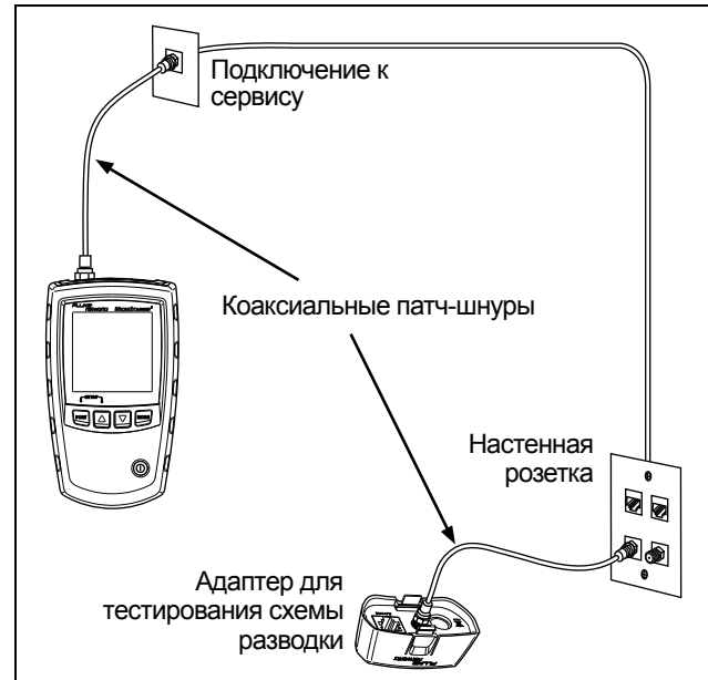
Рисунок 18. Подключение к коаксиальной среде
