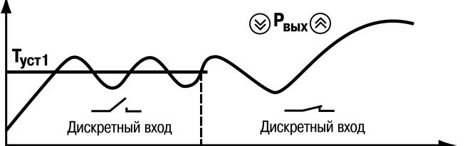
$InP.F = РУЧ1$  (ручной режим управления без смены Уставки при выходе);
