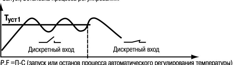
$InP.F = П-С$  (запуск или останов процесса автоматического регулирования температуры).
