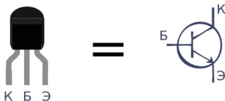
Слабым током, подаваемым на базу транзистора, можно управлять сильным током в цепи Эмиттер—Коллектор. Таким образом создается усиленная копия сигнала.
