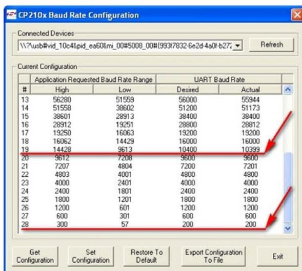
Воспользовавшись утилитами диагностики последовательных портов, можно проверить результаты выполненных действий, устанавливая скорости обмена, соответствующие переопределенным и сравнивая установленные и измеренные скорости.
