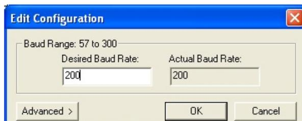
После того, как все изменения внесены, не забываем нажать кнопку Set Configuration в окне CP210x Baud Rate Configuration и проверить, что значения Desired и Actual в редактируемых строках изменились.
