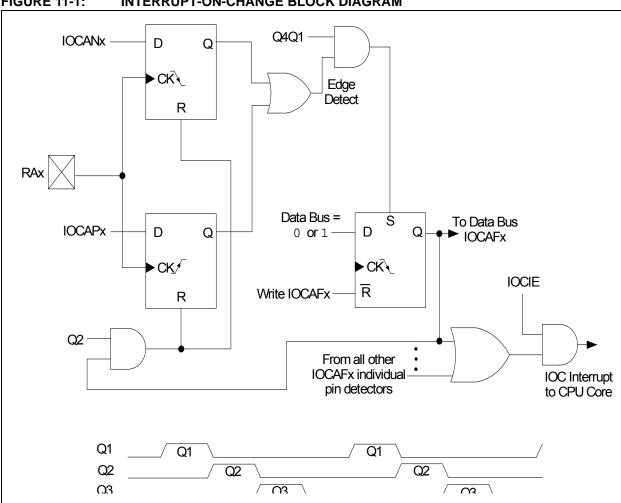
**FIGURE 11-1:** INTERRUPT-ON-CHANGE BLOCK DIAGRAM
