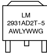
D2PAK D2T SUFFIX CASE 936
