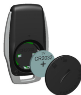
Figure 1 Remplacement de la batterie
