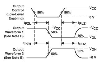
**VOLTAGE WAVEFORMS** PROPAGATION DELAY AND OUTPUT TRANSITION TIMES
