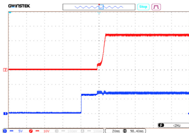
Рис. 22. Установление U_{\text{ВЫХ.НОМ}} с момента подачи ДУ (соединение выводов «ВКЛ» и «-ВХ»).
