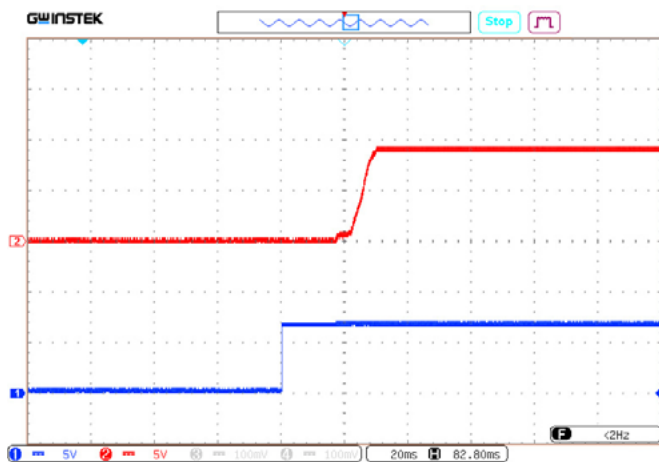
Рис. 18. Установление U_{\text{ВЫХ.НОМ}} с момента подачи ДУ (соединение выводов «ВКЛ» и «-ВХ»).
