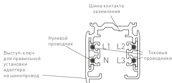
Рисунок 1. Конструкция шинопровода
