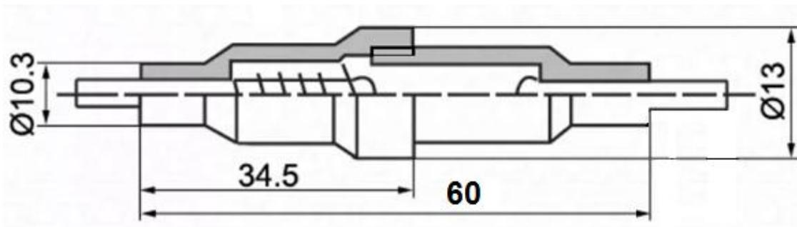
Предохранитель  $\varnothing 6 \times 30$ мм, стекло и керамика (приобретается отдельно)
