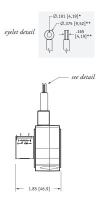
\* tolerance = +.005 -.001 [+0,1 -0,0] \*\* tolerance = +.005 -.005 [+0,1 -0,1]
