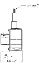
\* tolerance = +.005 -.001 [+0,1 -0,0] \*\* tolerance = +.005 -.005 [+0,1 -0,1]
