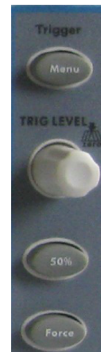
Рисунок 4.14. Поле управления системой запуска
