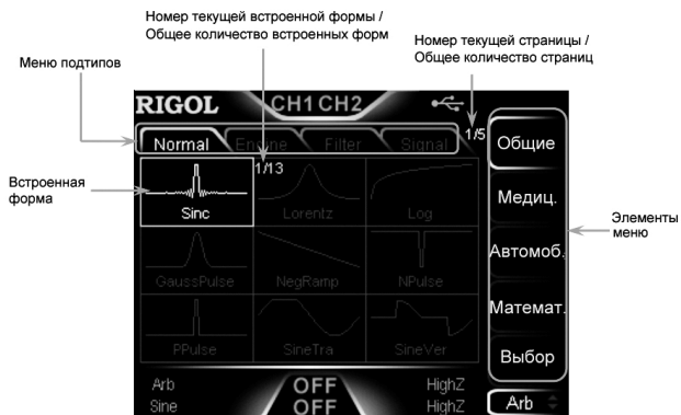
Предустановленные формы сигнала 160 типов предустановленных форм сигнала
