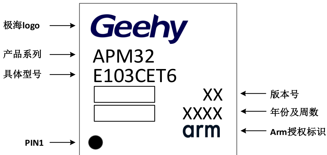
图 29 LQFP48-48 引脚, 7×7mm 标识图
