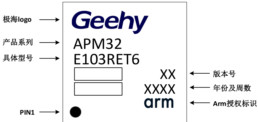
图 26 LQFP64 - 64 引脚，10 x 10mm 封装标识
