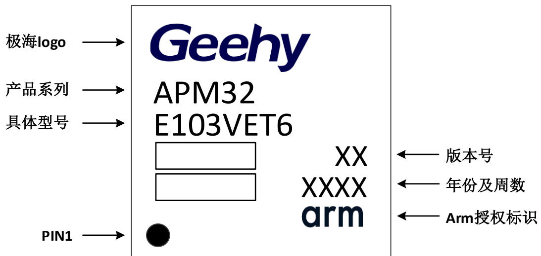
图 23 LQFP100 - 100 引脚，14 x 14mm 封装标识
