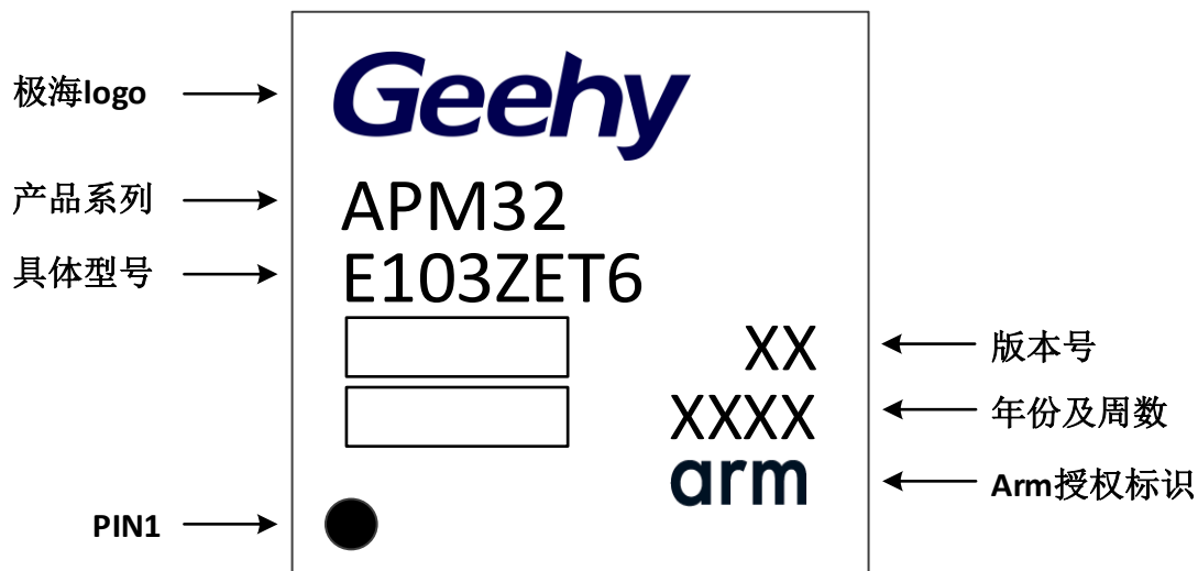
图 20 LQFP144 -144 引脚，20 x20 mm 标识图
