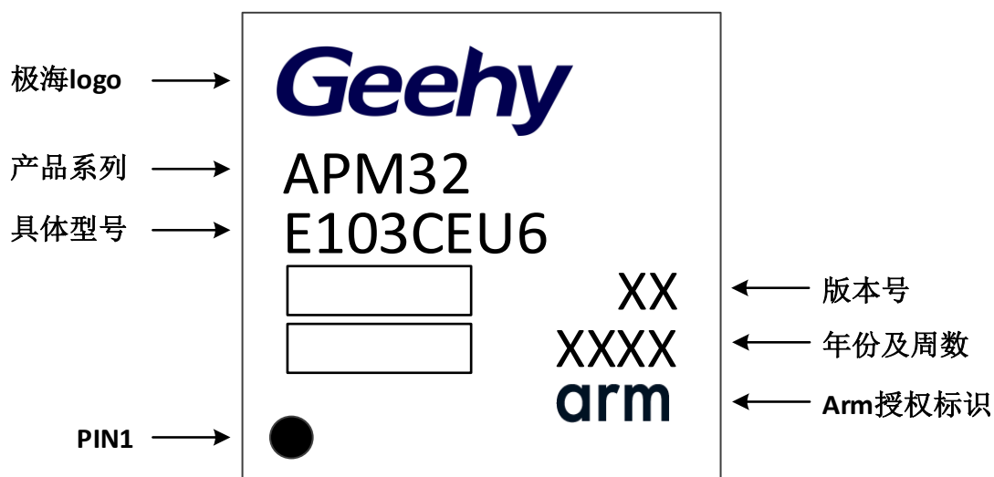
图 32 QFN48-48 引脚 7×7mm 标识图
