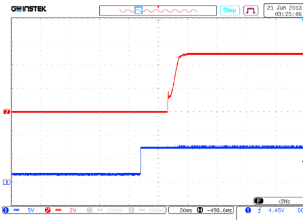
Рис. 24. Установление U_{\text{вых.ном}} с момента подачи ДУ (управляющий сигнал).
