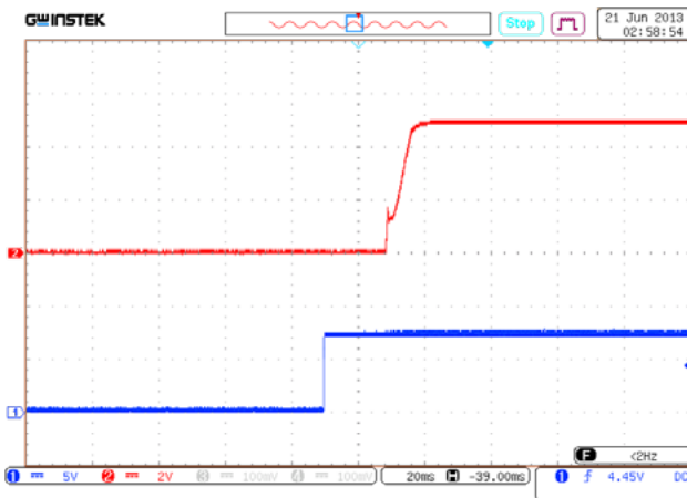
Рис. 23. Установление U_{\text{вых.ном}} с момента подачи ДУ (соединение выводов «ВКЛ» и «-ВХ»).
