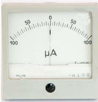
Амперметр М42102, микроамперметр М42102 предназначен для измерений постоянного тока.
