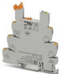
Morsetto base PLC da 6,2 mm con connessione Push-in, senza equipagg. relè o relè a stato solido, per il montaggio su guida di montaggio, NS 35/7,5, 1 contatti di scambio tens. di ingr.: 5 V DC
