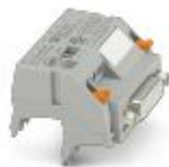
Adattatore V8 per 8 x PLC-INTERFACE (6,2 mm), controllore: Cablaggio di sistema PLC delle schede di uscita, collegamento 1: Connessione a vite 1x, collegamento 2: Connettore femmina D-SUB 1x 15-poli, collegamento 3: Attacco connettore (Può essere agganciato a scatto su 8 morsetti PLC-INTERFACE), numero di canali: 8, logica di comando: commutazione positiva
