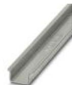
Guida di supporto, non perforata, Profilo standard 2,3 mm, larghezza: 35 mm, altezza: 15 mm, a norma EN 60715, materiale: Acciaio, zincato, passivato a strato spesso, lunghezza: 2000 mm, colore: color argento
