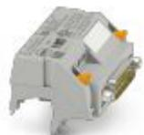
Adattatore V8 per 8 x PLC-INTERFACE (6,2 mm), controllore: Cablaggio di sistema PLC delle schede di uscita, collegamento 1: Connessione a vite 1x, collegamento 2: Connettore maschio D-SUB 1x 15-poli, collegamento 3: Attacco connettore (Può essere agganciato a scatto su 8 morsetti PLC-INTERFACE), numero di canali: 8, logica di comando: commutazione positiva
