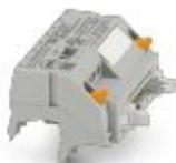
Adattatore V8 per 8 x PLC-INTERFACE (6,2 mm), controllore: Cablaggio di sistema PLC delle schede di uscita, collegamento 1: Connessione a vite 1x, collegamento 2: Connettore maschio IDC/FLK 1x 14-poli, collegamento 3: Attacco connettore (Può essere agganciato a scatto su 8 morsetti PLC-INTERFACE), numero di canali: 8, logica di comando: commutazione negativa
