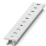
Nastro Zack, Striscia, bianco, siglato, siglabile con: CMS-P1-PLOTTER, siglatura longitudinale: numeri progressivi 1 ...10, 11 ...20 ecc. fino a 491 ...500, tipo di montaggio: inserimento a scatto in scanalatura alta portacartellini, per morsetti con spessore: 6,2 mm, dimensioni campo di siglatura: 6,15 x 10,5 mm, Numero dei cartellini singoli: 10
