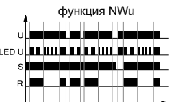
EWu + NWu Задержка включения на установленное время (EWu) или включение на установленное время - выключение на установленное время - постоянное включение, управляемые контактом S (NWu). ②
