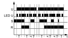
Esa(R) Задержка включения и выключения, управляемая контактом S, с функцией Сброс.
