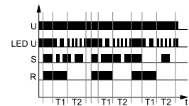
EWa Задержка выключения и отсчет времени выключения, запуск по размыканию управляющего контакта S. ②
