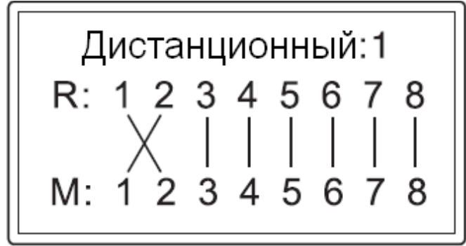
Перекрещенные провода (CROSS)
