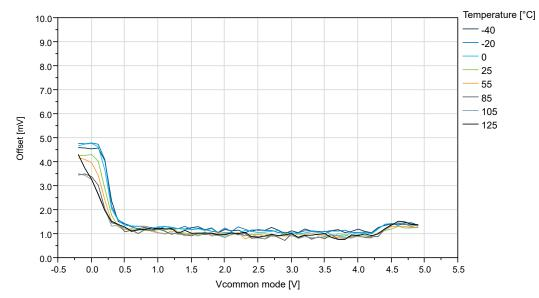
Figure 32-53. Offset vs. V<sub>CM</sub> - 10 mV (V<sub>DD</sub>=5V)
