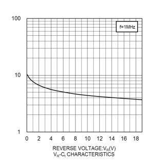
CAPACITANCE BETWEEN TERMINALS:C<sub>t</sub>(pF)
