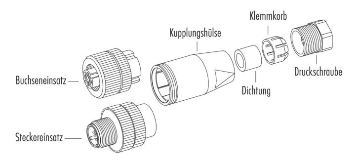
Material der Gewinderinge: Kunststoff, Zink Druckguss, Edelstahl
