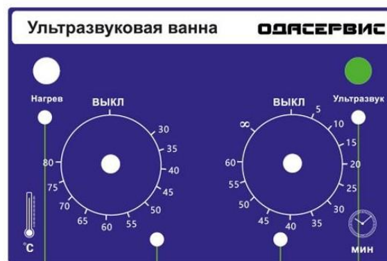
Индикатор работы нагрева Индикатор работы прибора Включение/Выключение нагрева Установка температуры нагрева Включение/Выключение таймера Установка времени работы прибора
